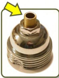
Um das Gewinderohr einzuschrauben zu können, vorher die kleine Schraube innerhalb der Fassung lösen. Dann Aufhängerung auf das Gewinderohr aufschrauben.
